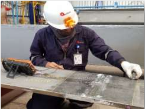
Ultrasonic Test (UT)
